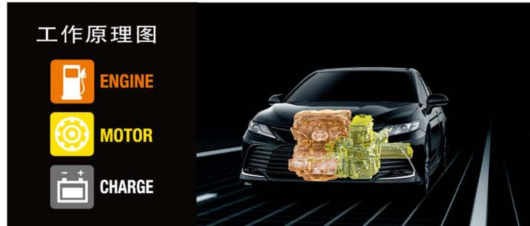
车辆加速时，发动机与电池系统同时为车辆提供动力，进一步提升整体驱动力。
