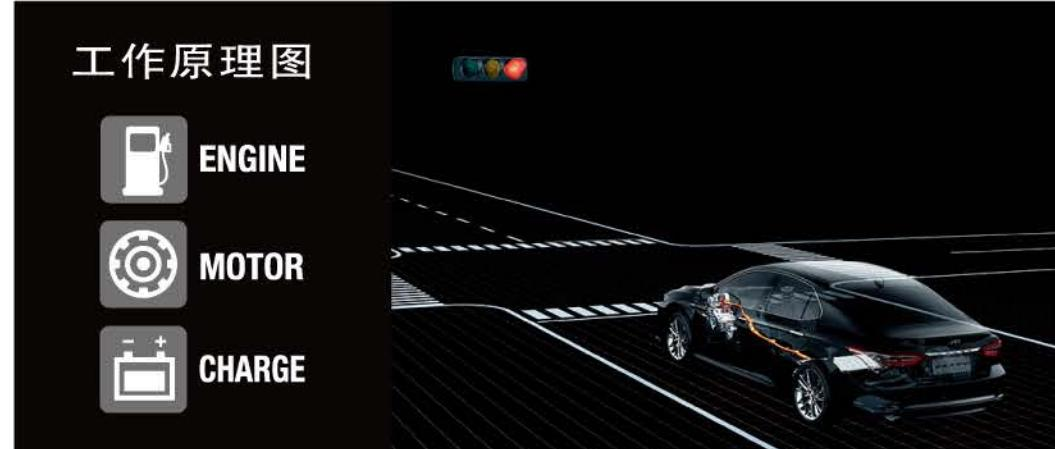
停车时，发动机和电动机停止工作(怠速停止<sup>\*1</sup>)，不消耗燃油，空调仍可正常使用。
