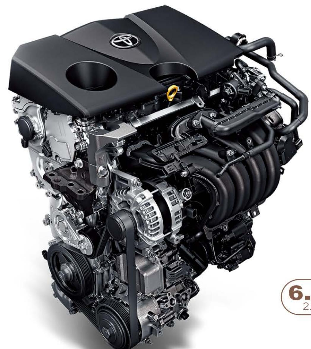
2.0L Dynamic Force Engine 发动机 + 模拟 10 速 Direct Shift-CVT 变速箱
