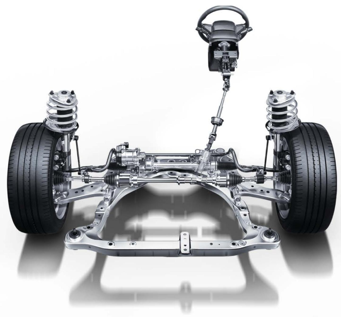
高精度齿条并行式电动助力转向系统
