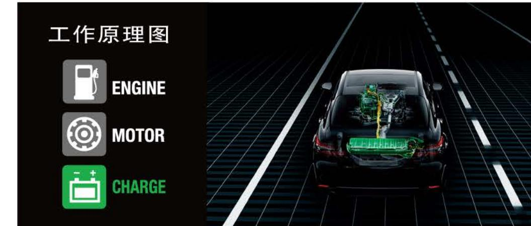
车辆减速时，车轮驱动电动机发电，为电池充电，实现能量的回收。
