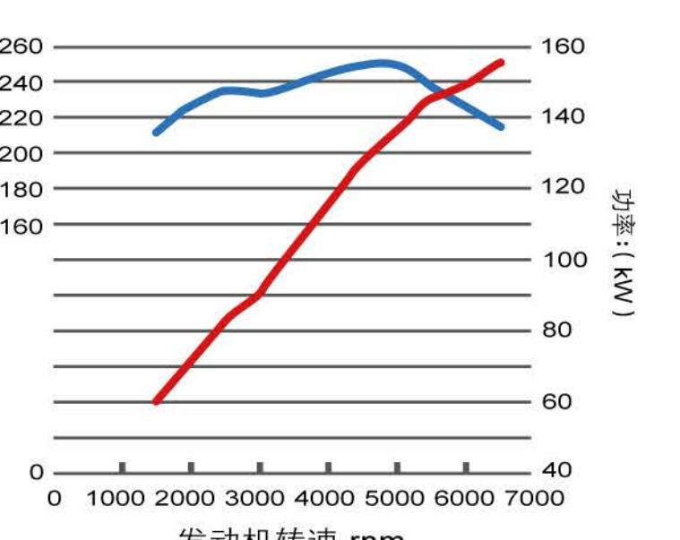
2.5L 直列四缸发动机是丰田 TNGA(丰田新全球架构)的重要成果之一，采用了 VVT-iE 智能电动可变气门正时进气系统，D-4S 缸内直喷+进气歧管喷射双喷射系统和激光熔覆气门座等大量新技术，实现了更高的输出功率和更高的燃油效率，达到了高性能、高燃油经济性和低排放的高度融合。
