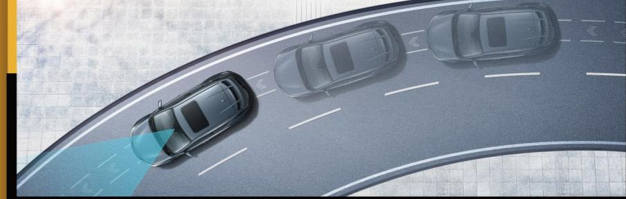
为确保车辆在车道中央行驶,对部分转向操作进行支援<sup>1</sup>。在堵车等白线(黄线)难以看清或看不清的情况下,追随先行车辆、提供部分必要的转向操作,以保持车辆在车道中央行驶。即将越过行车线时,发出提醒和显示屏提示,辅助部分转向操作。
