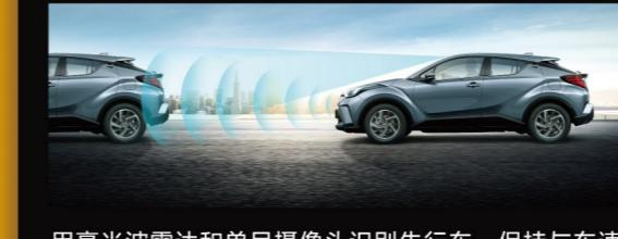
用毫米波雷达和单目摄像头识别先行车,保持与车速相对应的跟车距离的同时辅助跟车行驶。当先行车辆停止时自身车辆也会停止,并保持停止状态,在先行车起步时,由驾驶员操纵起步并再次进行跟车行驶。在高速公路等驾驶场合,减少驾驶者的驾驶负担。
