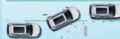
根据车辆的负荷和道路状况，自动分配前后轮的制动力，保证车辆在多种路面(如湿滑路面)上制动的稳定性。
