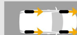
扭矩分配至后轮，以提高湿滑路面的起步性能。
