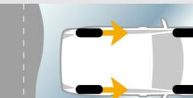
扭矩分配至后轮，以提高转弯或湿滑路面上的驾驶性能。
