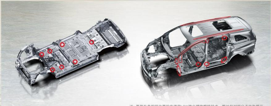
注：两侧车身相同位置均有使用LSW激光螺旋焊接技术，图片仅对部分点位作展示。
