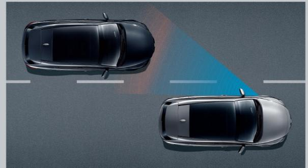
通过雷达检测行驶在侧面车道的车辆，一旦检测出视线盲区中难以确认的侧后方车辆，便通过后视镜的LED指示灯提醒驾驶者注意。
