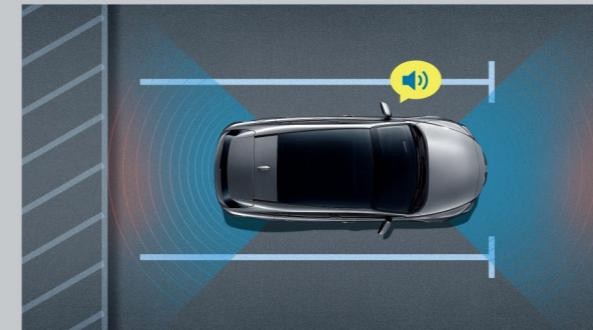
该系统可缓和因误踩油门踏板或踩踏用力而引起的冲击，减轻损害。在倒车入库等情况下，探测到接近静止物时，会通过屏幕显示和蜂鸣器发出警报，控制起步时的输出功率，若距离仍持续缩小，将自动刹车，减轻损害。
