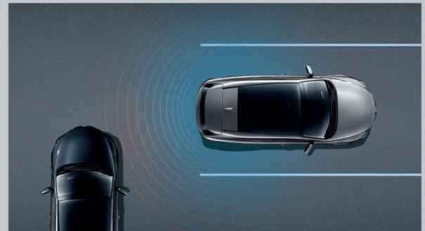
车辆倒车时，依靠雷达检测左右侧后方是否有车辆靠近，并可通过后视镜上的指示灯与蜂鸣器提醒驾驶者注意。当系统检测到存在碰撞的危险时则自动刹车，减轻和靠近车辆的冲击损害。
