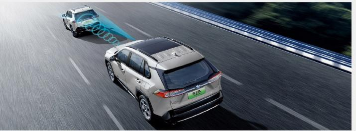
通过毫米波雷达和单目摄像头识别前方车辆，保持与车速相对应的跟车距离的同时辅助跟车行驶。当前方车辆停止时自身车辆也会停止，并保持停止状态；当前方车辆起步时，由驾驶者操控起步并再次进行跟车行驶。在高速公路等驾驶场合，减少驾驶者的驾驶负担。
